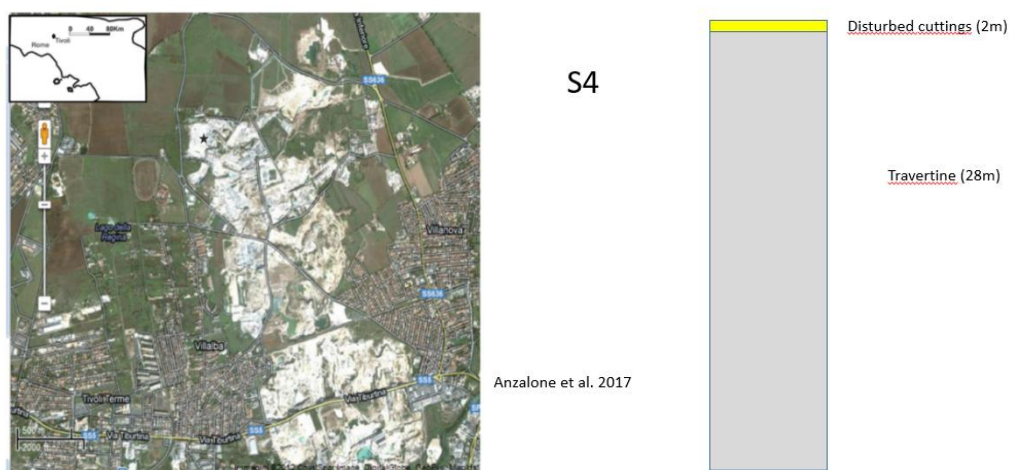
Figura 1.6.6. a. Ubicazione del sondaggio (stella); b. Stratigrafia ottenuta dal sondaggio (Anzalone et al., 2017).
