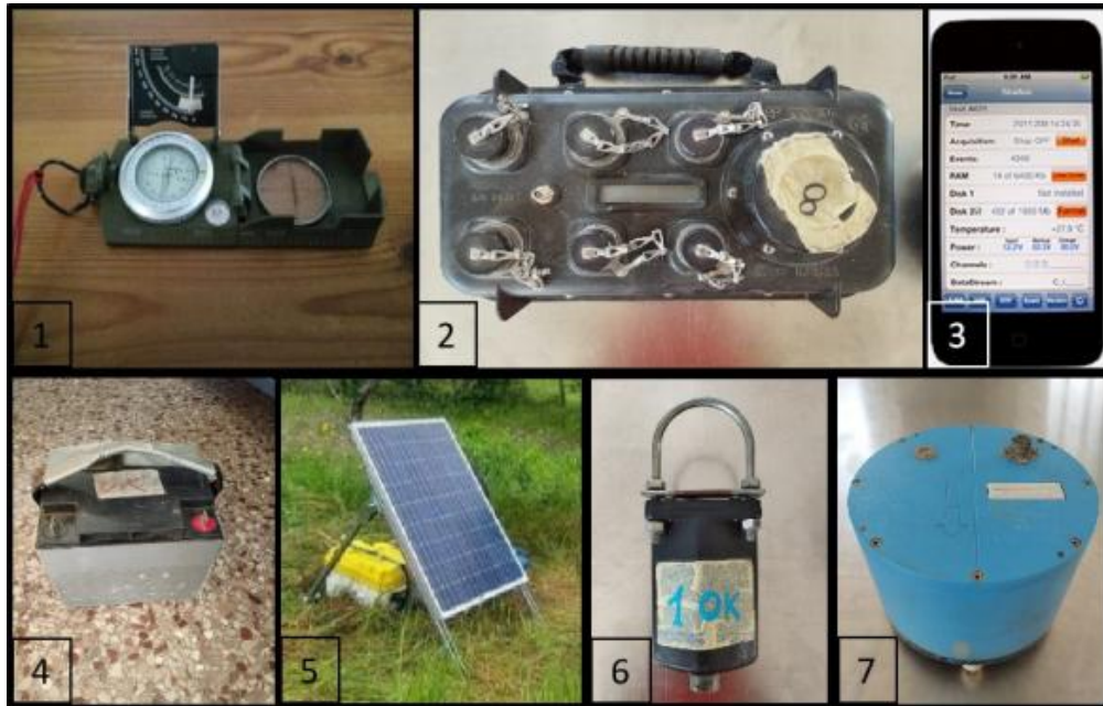
Figura 2.5.1.1. Strumentazione Rumore Ambientale: 1. Bussola; 2. Reftek; 3. iPhone; 4. Batteria; 5. Pannello solare; 6. GPS; 7. Sensore.
