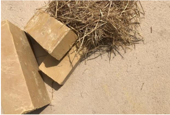
Figura 4.33: Blocchi in terra compressa (fonte: Terra cruda, https://terracruzaitalia.com/it/sistemi/componenti-costruttivi , ultima consultazione 18/08/2023).
