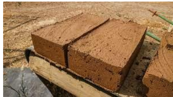
Figura 4.32: Mattone in Adobe (fonte: un passaggio per biotopia, https://www.unpassaggioperbiotopia.org/materiali/principali-tecniche-di-posa-con-la-terra/adobe/?doing_wp_cron=1692347236.8559050559997558593750 , ultima consultazione 18/08/2023).
