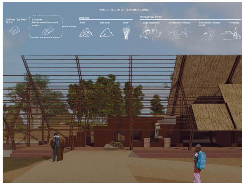
Figura 4.49: III fase: realizzazione delle pareti in terra cruda.
