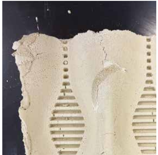
Operazione di stuccatura della piastrella con materiale Inertial Foto scattata nel Centro di Competenza VALORE
