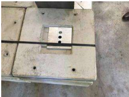
Figura 2.13 e 2.14 – Prototipo trave con foro cilindrico e quadrato con “cerniera” installata
