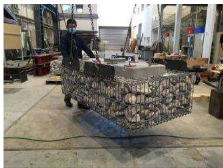
Figure 2.17 e 2.18 – Installazione pannello di copertura e movimentazione gabbione
