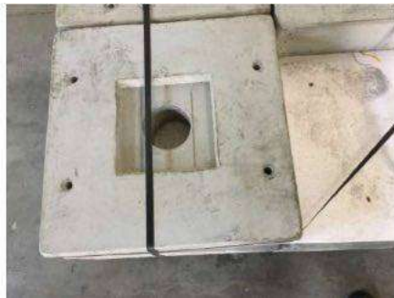
Figura 2.13 e 2.14 – Prototipo trave con foro cilindrico e quadrato con “cerniera” installata
