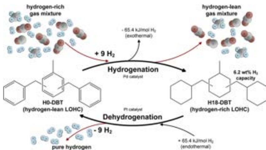
Figura 7.6: Idrogenazione e deidrogenazione del LOHC dibenziltoluene.
