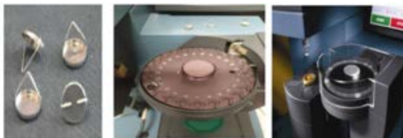
Figura 10.2: Dettaglio dei crogioli in platino usati in TGA, dell'autocampionatore e del fornello.
