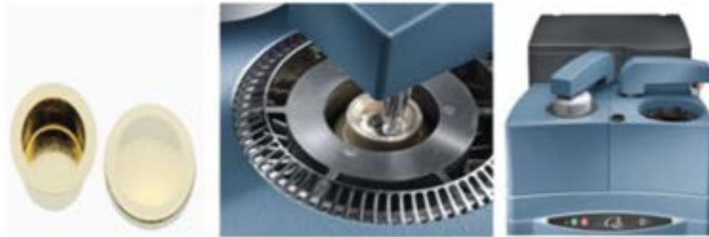
Figura 10.4: Da sinistra: crogiolo in alluminio per le misure DSC, fornello e autocampionatore, strumento DSC.
