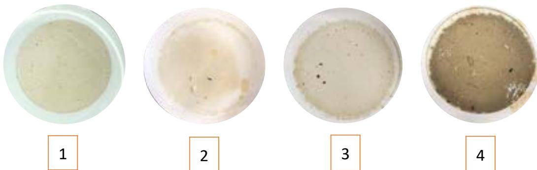
*Figura 2.16. Filtri in esteri misti di cellulosa ottenuti mediante filtrazione del surnatante con l'utilizzo di una soluzione satura di NaCl.*
