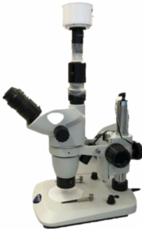
*Figura 2.19. Microscopio ottico utilizzato per l'analisi delle microplastiche.*
