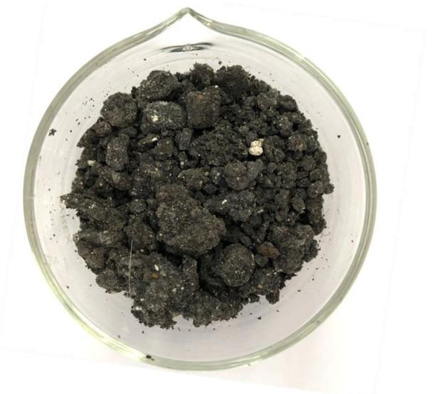
*Figura 2.4. Digestato essiccato in serra (bioessiccazione).*
