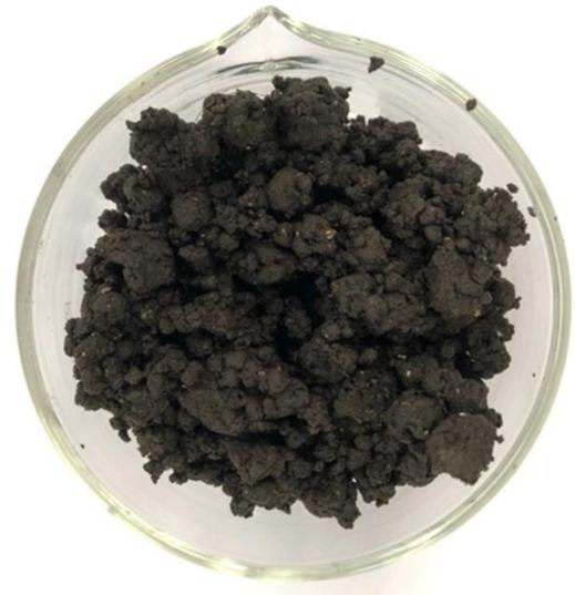
*Figura 2.3. Digestato disidratato tramite centrifugazione.*
