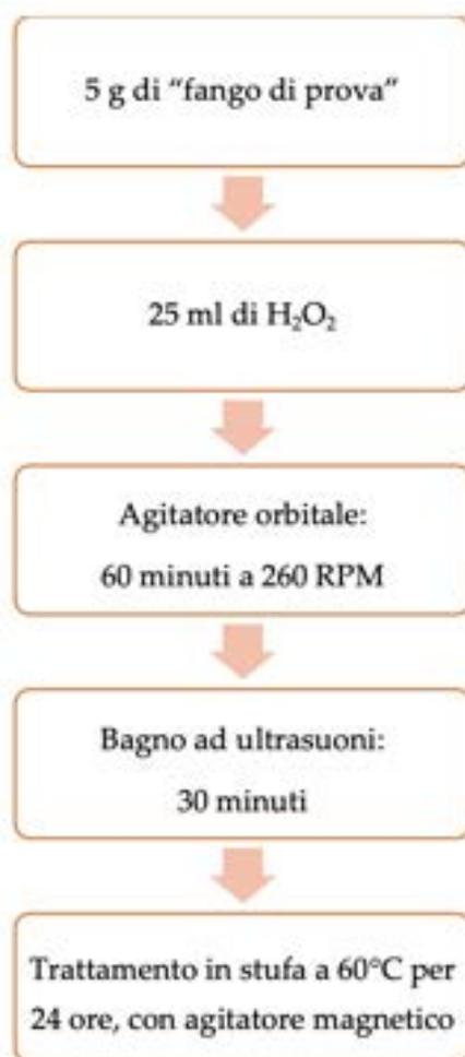
Figura 2.12. Trattamento chimico con l'utilizzo di H<sub>2</sub>O<sub>2</sub>.
