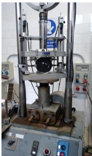
*Figura 10 - Campione sottoposto a prova di trazione indiretta*
