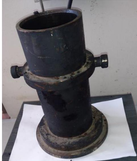
Figura 6 - Fustella da 100 mm per la preparazione dei provini
