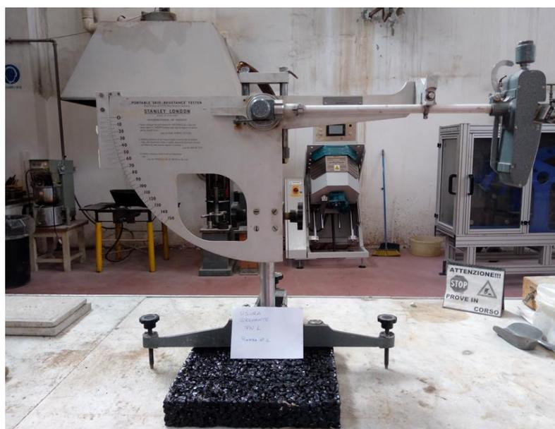
Figura 18 - Strumento portatile per l'esecuzione dello Skid tester
