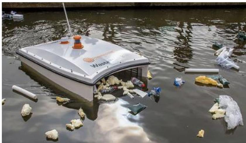
*Figura 1 - Plastic - eating drone in atto di rimozione di plastiche inquinanti*
