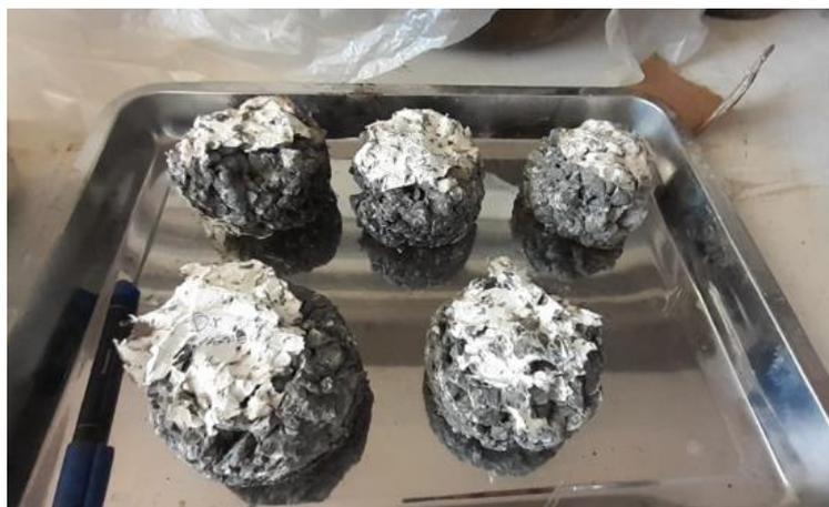
Figura 13 –provinci in conglomerato bituminoso con cui è stata svolta la prova Cantabro
