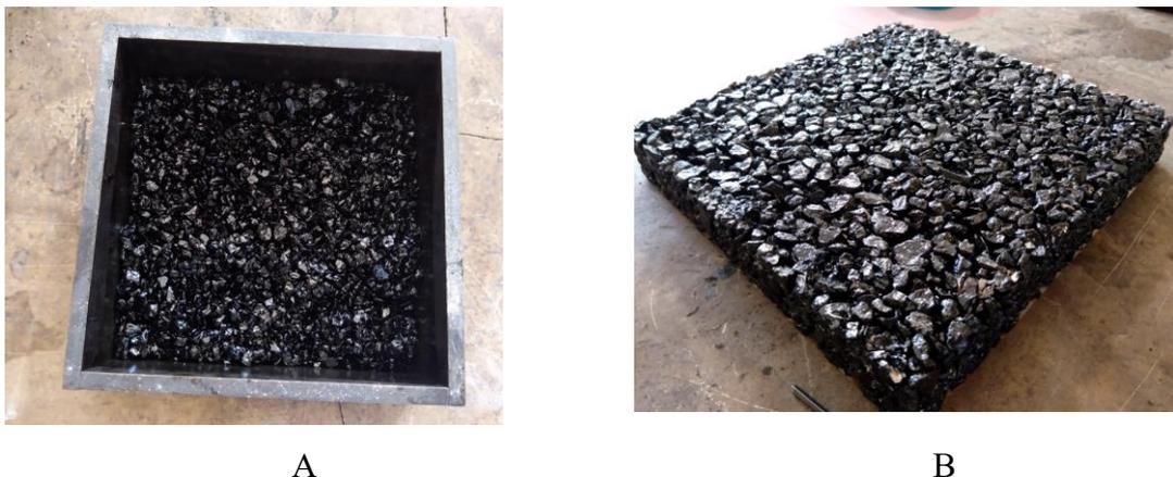
Figura 16 – Piastra in conglomerato bituminoso utilizzata per le prove superficiali;
