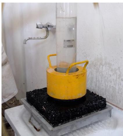
*Figura 19 – Cilindro graduato con apposito collare per la prova di permeabilità*
