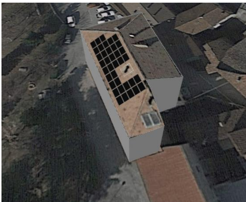
Figura 5.14 - Impianto installabile - Scuola Primaria di Priola (CN)
