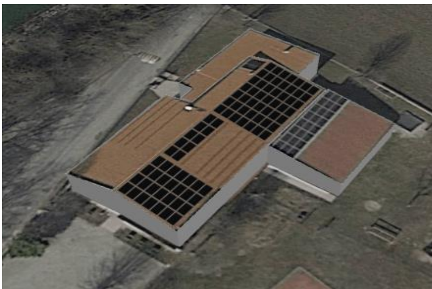
Figura 5.11 - Impianto installabile - Scuola Primaria di Nucetto (CN)
