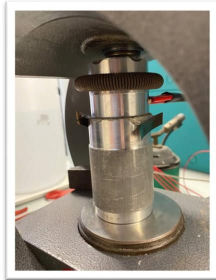
*Figure 9: particolare dei cilindri con resistenze posizionate in pressa. Si può osservare come in un primo momento son stati utilizzati degli spessori rettangolari risultati inutili, in quanto in fase di pressa, scivolano fuori.*
