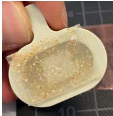
Figure 24: Campione di PLA e lolla in rapporto 50:50 ritagliato 2 cm x 2,5 cm e fissato mediante bi-adesivo al supporto inferiore della "Clamping Cell"
