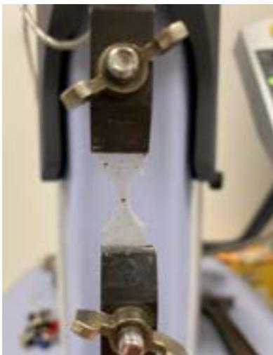
Figure 21: Campione Dog Bone di PLA Puro in posizione, nelle pinze dell'UTM, per eseguire tensile test
