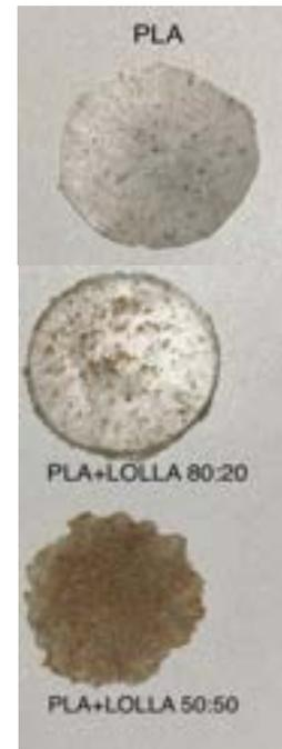
Figure 11: Risultati fusione PLA e PLA arricchito con lolla in rapporto 50:50 o 80:20
