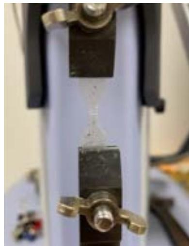
Figure 22: Campione di PLA Puro che ha subito il tensile test e si evidenzia il solco di rottura
