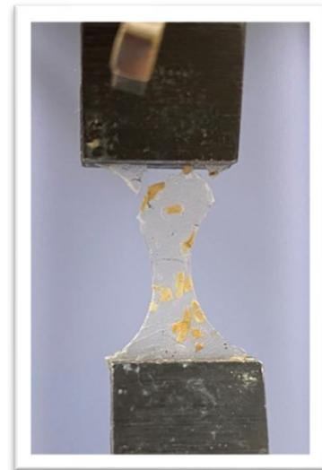
Figure 61: Particolare della rottura del terzo campione di PLA con Lolla in rapporto 50:50 riportato nel grafico in Fig. 60
